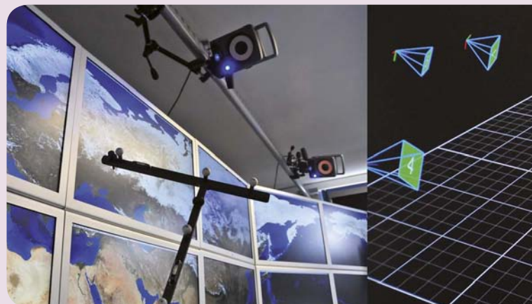
Système VICON à base de caméras pour le suivi de marqueurs passifs
