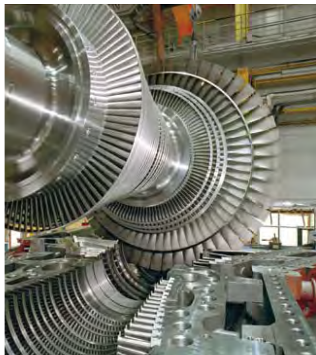
« Turbine à vapeur Alstom.
