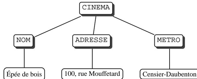
FIG. 2.1 – Représentation arborescente d'un contenu XML
