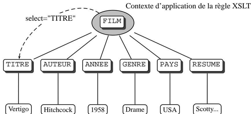
FIG. 2.5 – Extraction des informations dans une règle XSLT
