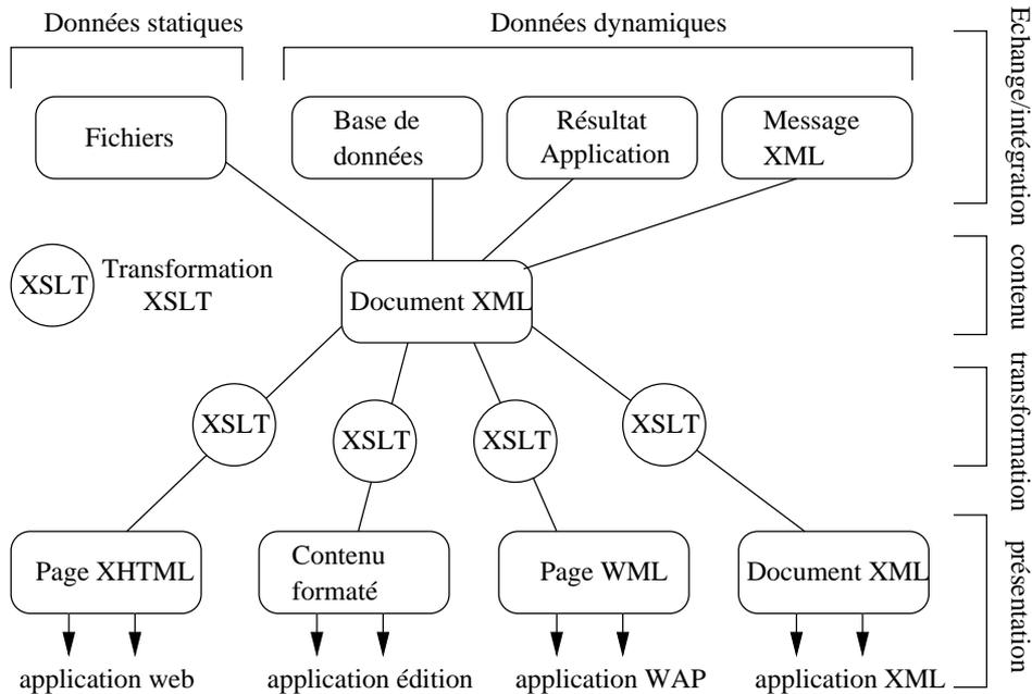
FIG. 2.20 – Intégration XML, et transformations XSLT
