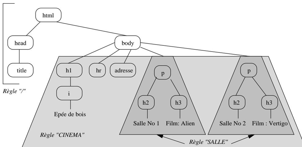
FIG. 2.11 – L'arbre HTML, résultat de la transformation XSLT
