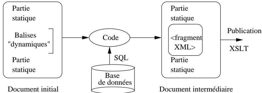
FIG. 2.19 – Architecture d'une intégration XML/Base de données
