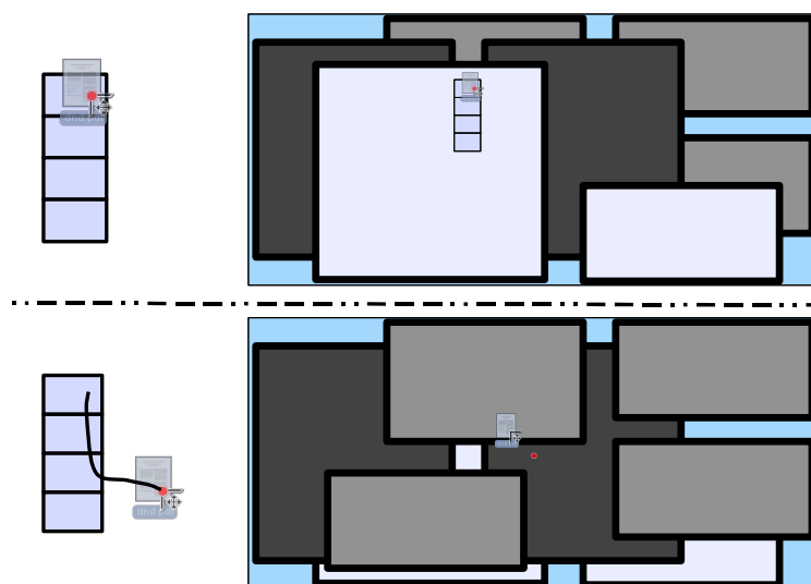
FIGURE 2.7 – Un exemple de l'utilisation de la technique StackLeafing . L'utilisateur choisit de révéler la troisième couche de fenêtres en descendant de deux "cases" dans la pile puis en quittant la case par le côté.
