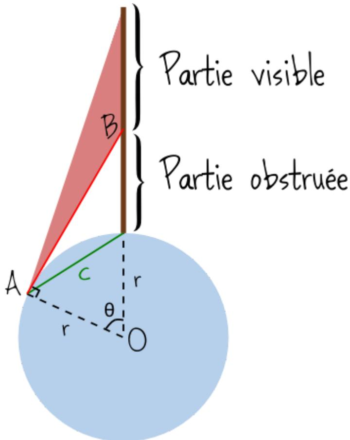
Faisons un peu de géométrie. J'ai tracé un schéma ci-contre, où j'ai évidemment exagéré les dimensions pour les besoins de la cause. Le rayon de la Terre est  $r$ , le mat est située à une distance  $c$  (mesurée en ligne droite) de l'observateur A. Quelle est la taille de la partie obstruée ?
