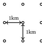
Les émetteurs ont une portée maximale de 900m. En conséquence, deux émetteurs distants de plus de 1,8km ne sont pas actifs au même endroit.
