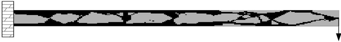
FIG. 4.23 – *Structure optimale sur le maillage  $200 \times 20$  pour le cantilever  $10 \times 1$ .  $D_{lim} = 12$ ,  $D_{max} = 11.99$ , poids = 44.5%. Temps CPU = 28s/génération.*
