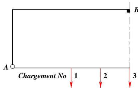
FIG. 4.33 – Pont2D - Les cas de charges pour l'optimisation en multi-chargements.
