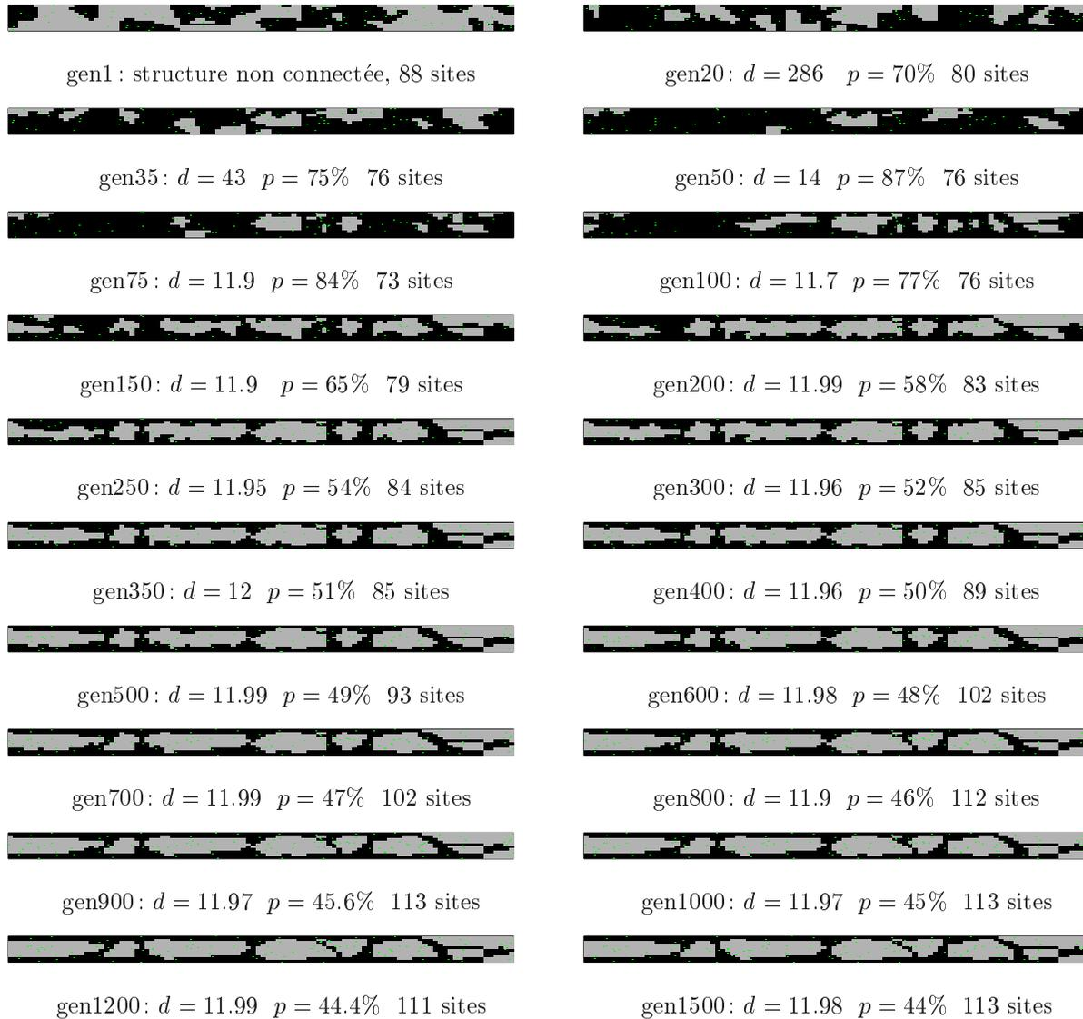
FIG. 4.24 – Evolution de la meilleure structure au cours des générations. maillage  $100 \times 10$ ,  $D_{lim} = 12$ . temps CPU = 5 à 6s/génération (120 individus).  $p$  désigne le poids et  $d$  désigne le déplacement maximal de la structure.
